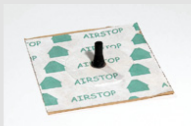
Samolepicí průchodka, která se přilepí na parozábranu nebo parobrzdou. Průchodkou může procházet např. vodovodní potrubí nebo elektrický kabel při zachování parotěsnosti a vzduchotěsnosti tohoto průchodu parozábranou
